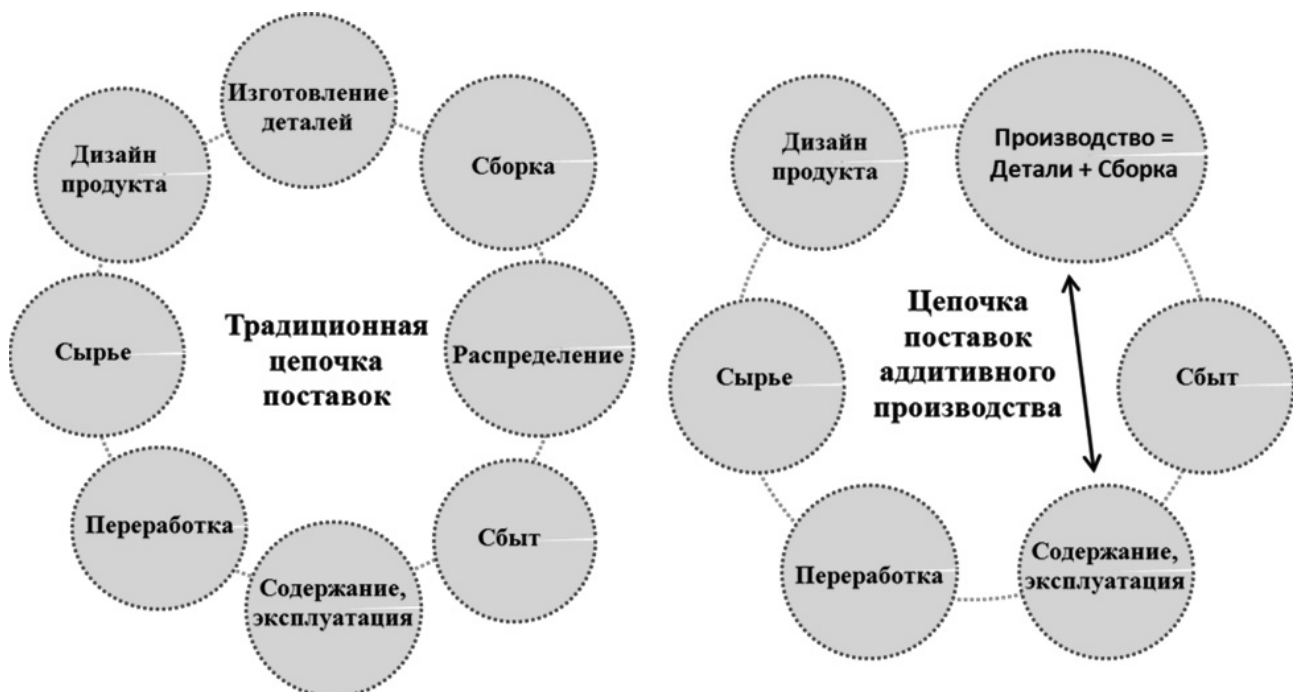
Рис. 2. Сравнение структуры и протяженности цепочек поставок в традиционном и аддитивном производстве
